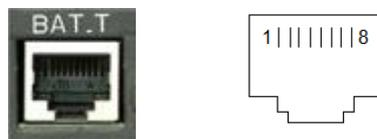
Рис. 5-7 Конфигурация выводов и нумерация контактов интерфейса BAT\_T (RS485)
